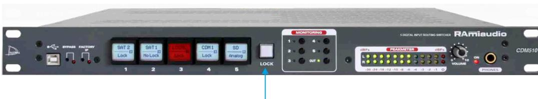
Au démarrage de l'appareil, appuyez sur la touche "Lock" pendant environ 4 secondes.
