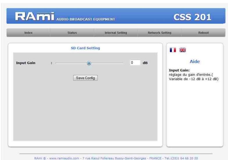
**Input Gain :** Réglage du niveau d'entrée de la carte SD. Variable de -12dB à +12dB.
