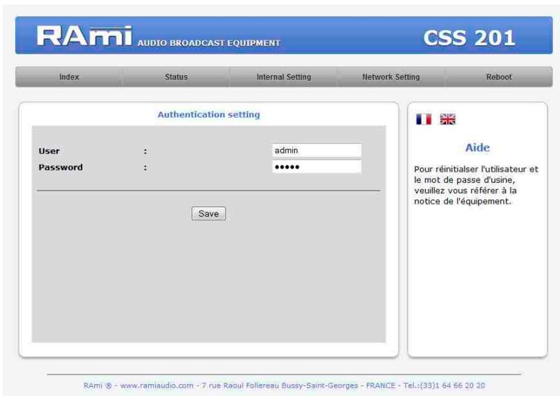
Page de configuration de l'utilisateur et du mot de passe. Nécessaire pour accéder aux pages de configuration de l'appareil.
