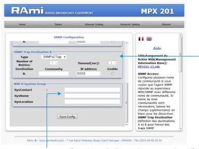
MIB II system group: configuration par l'utilisateur du groupe système défini dans le standard SNMP.
