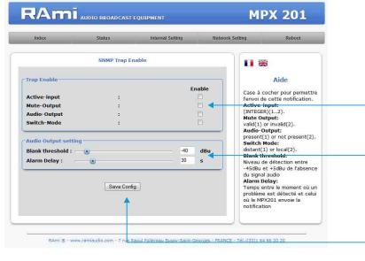
Checkbox d'activation de l'envoi d'une trap SNMP pour chaque changement de valeur sur les différentes variables associées.
