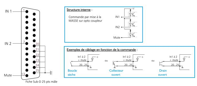
E - Embase Sub-D 25 points mâle de sortie GPO et fonction Mute. 2 sorties boucles sèches pour l'indication du canal 1 et du canal 2 pour la commutation RDS.
