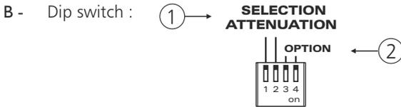
① ► Réglage de l'atténuation de l'entrée AUX en présence d'entrée ORDRE (Variable de -6 dB à -24 dB).
