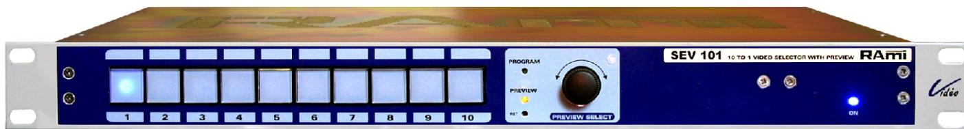
Le **SEV 101** est un sélecteur de source vidéo composite au format rack 19", 1U. Il permet de choisir 1 source vidéo composite parmi 10. Un mode de prévisualisation permet de sélectionner une des entrées vidéo vers la sortie "Preview" pour effectuer un contrôle visuel avant de la sélectionner en sortie "Program".
