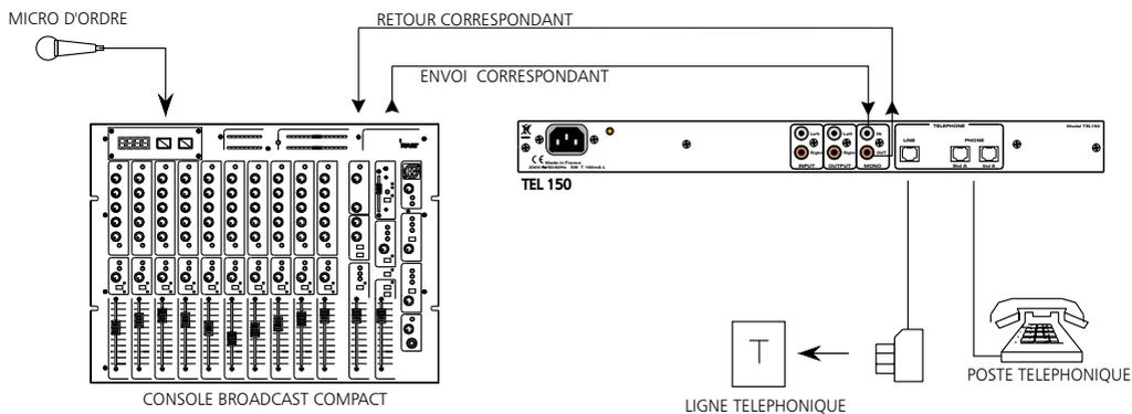
3 ) Utilisation en insertion sur un départ pour une console ne disposant pas de voie spécifique "INSERT".
