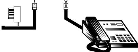
Attention ! suivant le type d'appareil téléphonique utilisé, le câblage du cordon n'est pas identique. Le TEL 150 dispose donc de 2 standards de connexion pour pallier à ce problème.
