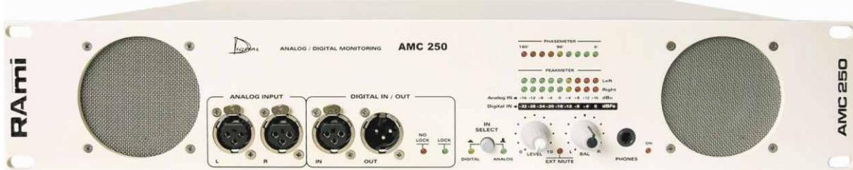
L'AMC250 est un boîtier d'écoute locale amplifiée au format rack 19" - 2 Unités, possédant une entrée audio analogique ainsi qu'une entrée audio numérique. Cette dernière accepte tous les formats standards (AES/EBU, S/PDIF, IEC 958) jusqu'à une résolution de 24 bits et une fréquence d'échantillonnage maximale de 96 KHz.
