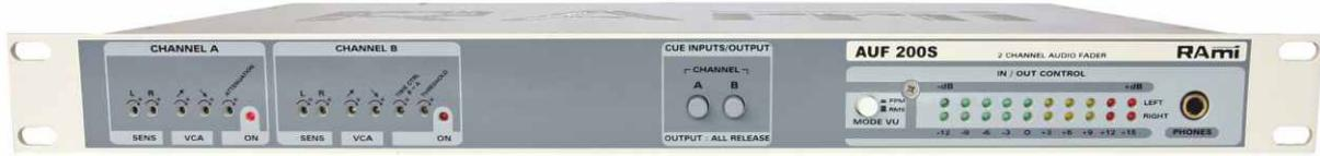
L'**AUF200S** comprend deux canaux A et B stéréophoniques symétriques mixés vers un départ symétrique. La transition du canal A vers le canal B et réciproquement s'effectue par un mixage électronique (fondu enchaîné) dont on peut modifier les paramètres. Le passage d'un canal à l'autre peut s'effectuer, soit sur la présence de la modulation, soit sur la fermeture d'une boucle extérieure, soit sur une combinaison des deux.
