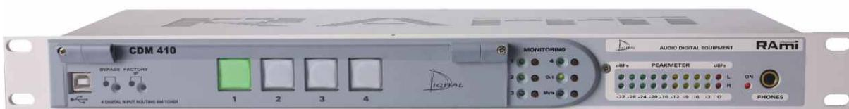
Le **CDM410** permet de sélectionner une source audio numérique parmi quatre. Une partie monitoring permet à l'utilisateur de contrôler à chaque instant les entrées/sorties du **CDM410**. Un convertisseur D/A 24 bits 96KHz intégré fournit une sortie analogique symétrique sur une Sub-D 9 en face arrière, une sortie casque et un bargraph pour un contrôle efficace des signaux.
