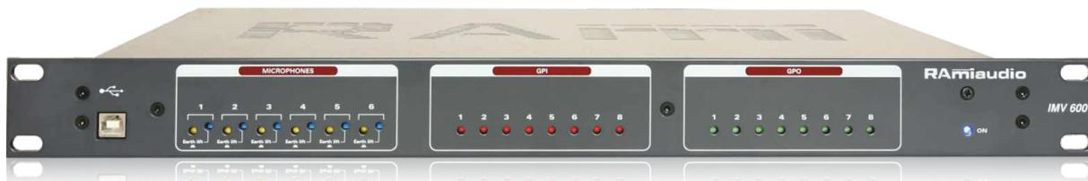
L'IMV600 permet l'ouverture et la fermeture automatique de caméra vidéo par la détection du signal audio de 6 microphones en environnement studio radio. Cela permet lors de la diffusion vidéo d'une émission de commuter automatiquement la caméra pointée vers le journaliste à l'antenne.
