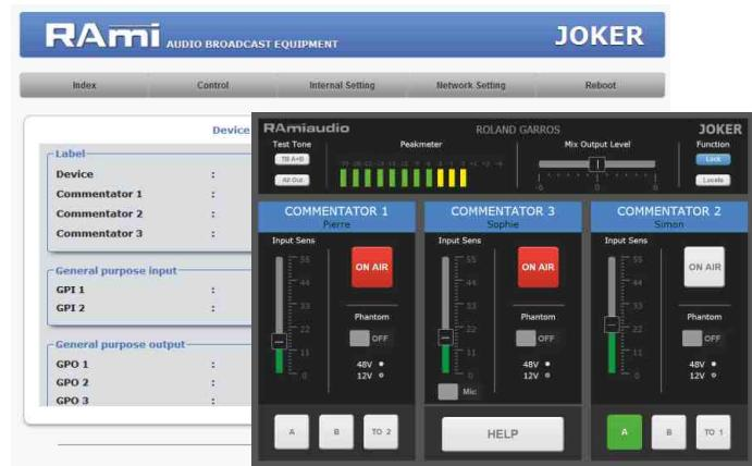
Configurer et contrôler l'appareil à distance grâce au serveur web embarqué. L'ensemble des réglages des pré-amplis et des commutations sont accessibles en temps réel (sensibilité, ON AIR, alim. fantôme, talkback...)
