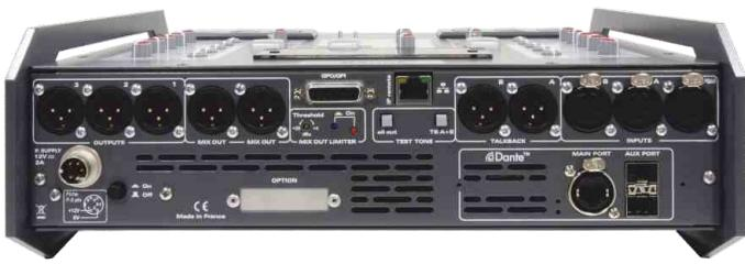
Le JOKER propose des entrées/sorties GPI/GPO sur un connecteur Sub D-15. Elles permettent de commander ou d'avoir le reflet de l'état "ON AIR" de chaque commentateur. Le mode IP permet une utilisation en stand alone.
