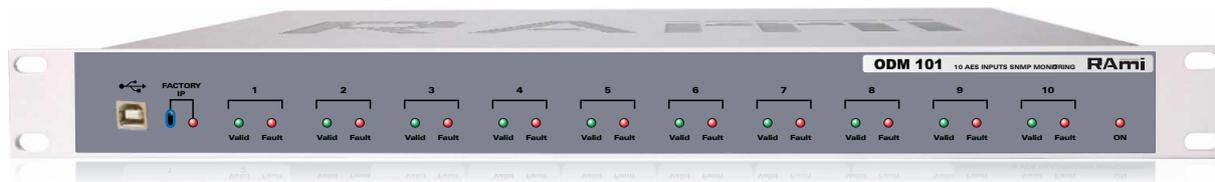
Cet équipement permet de vérifier la qualité et les paramètres de 10 liaisons numériques AES/EBU en permanence. L'**ODM101** est capable de tester plusieurs types d'erreurs réparties en deux groupes :
