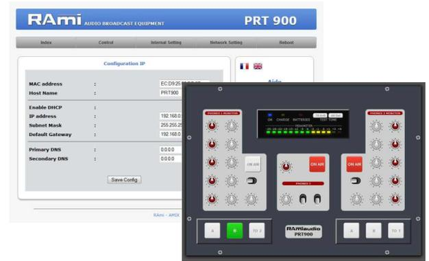
Le serveur web embarqué permet de configurer et de contrôler l'appareil à distance.
