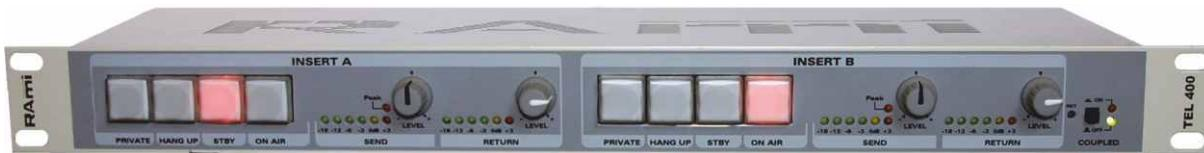
Le **TEL400** est un double insert téléphonique permettant sur une unité 19", de gérer deux lignes RTC, c'est à dire deux correspondants avec fonction full duplex intégrée. L'architecture du **TEL400** s'articule autour d'un système hybrid numérique permettant la gestion avancée d'annulation d'écho sur les lignes RTC. Cette architecture permet une optimisation de la qualité audio du signal retour correspondant.
