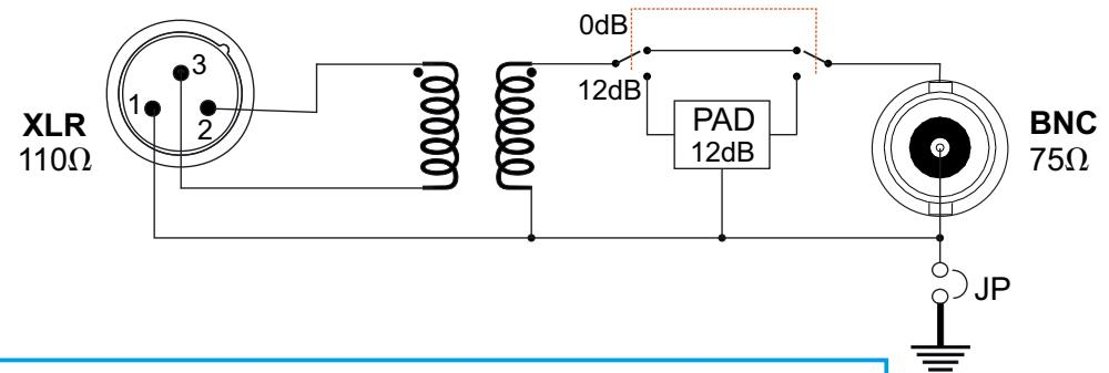
Le cavalier JP permet de connecter le potentiel du boîtier à la masse de la XLR et BNC. Si 4 Vcc sur XLR  $\Rightarrow$  3,3 Vcc ou 1 Vcc sur BNC.
