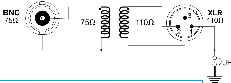
Le cavalier JP permet de connecter le potentiel du boîtier à la masse de la XLR et BNC. Si 1 Vcc sur BNC  $\Rightarrow$  1,2 Vcc sur XLR
